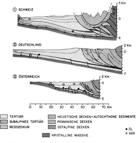
Fig. 17: Molassebecken – Geologische Profile, 3 x überhöht
