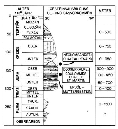
Fig. 9: Pariser Becken - Schichtfolge und Mächtigkeiten
