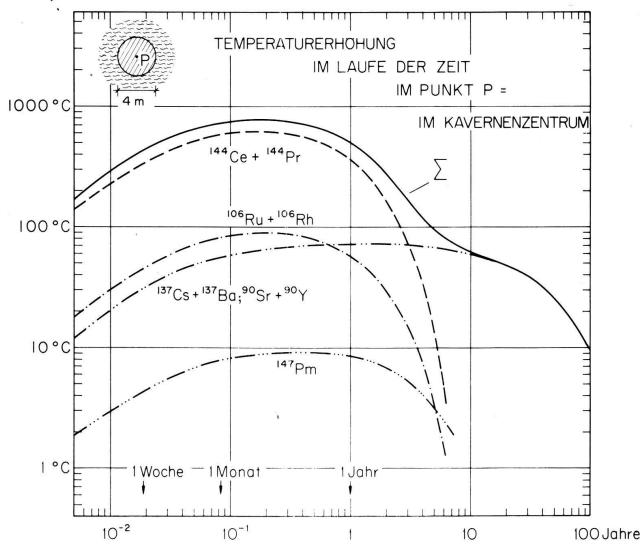
Fig. 2: Aufheiz-Effekt der thermisch wirksamen Radioisotope (vgl. Tab. 4) im Abfall, gelagert in einer Kaverne mit 2 m Radius in Anhydrit, im Laufe der Zeit. Die ausgezogene Kurve ist die Summe der Einzel-Effekte der angegebenen Isotope. Die Aufheizung erfolgt rasch, die Abkühlung sehr langsam.
