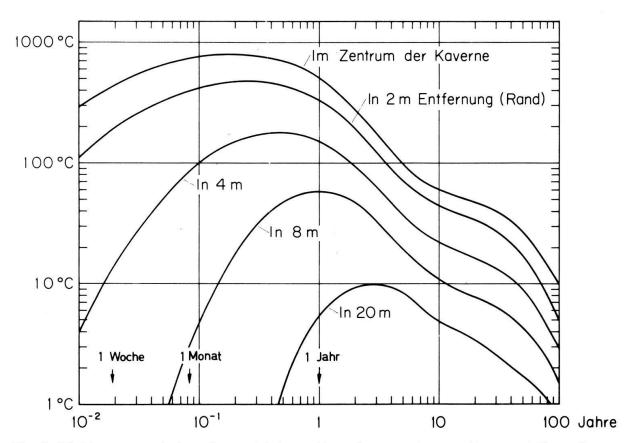
Fig. 3: Die Temperaturerhöhung in verschiedenen Abständen vom Kavernen-Zentrum. Mit zunehmender Entfernung trifft die Temperaturwelle immer später ein, wobei die Spitzentemperatur immer mehr abnimmt. In 20 m Entfernung beträgt die Temperaturerhöhung nur noch 10°C.
