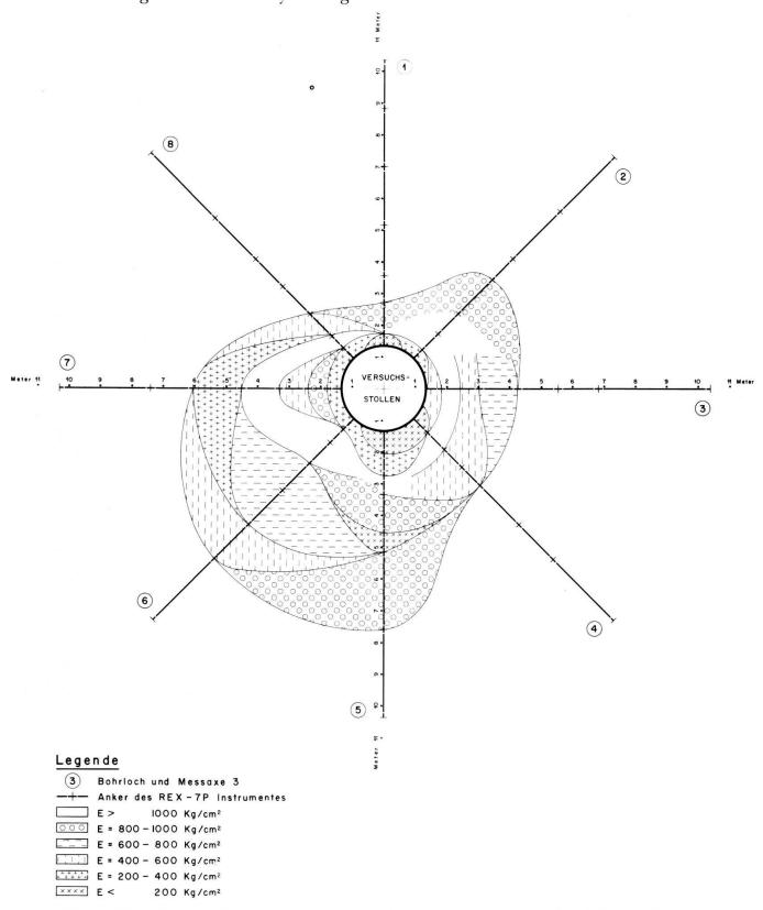
Abb. 4: Übersicht über die Verformungsmoduli der einzelnen Messabschnitte bei Innendruck  $p_i = 70 \text{ kg/cm}^2$ .
