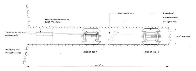
Abb. 2: Prinzipskizze des REX-7P Messinstrumentes mit Ankerköpfen.
