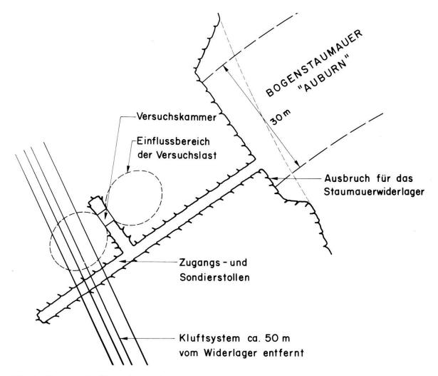
Abb. 1: Situation der Versuchsanordnung.
