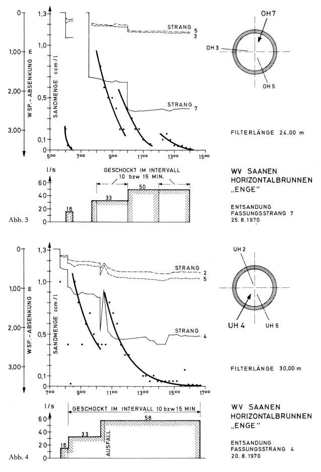
serproben-Entnahme zur Kontrolle des mitgeführten Sandes erfolgte während des Schockens, jeweils kurz nach Einschalten der Pumpe, also im Zeitpunkt des grössten Sandschwalles.
