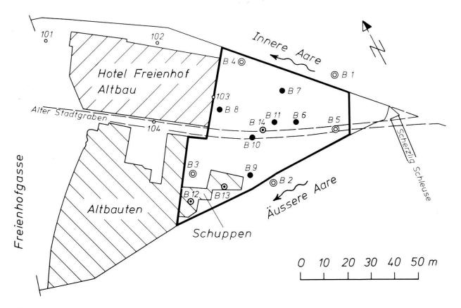
Abb. 1: Lage des Bauareals zwischen Innerer und Äusserer Aare. Situation der 14 durchgeführten Sondierbohrungen.
