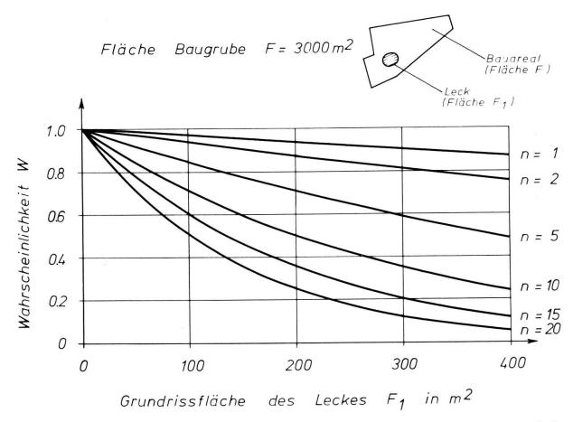
Abb. 9: Wahrscheinlichkeit W, dass ein Leck von der Fläche F<sub>1</sub> im Seelehm bei n Bohrungen unentdeckt bleibt.
