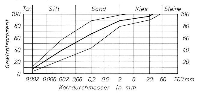
Abb. 4: Mittlere Kornverteilung mit Standardabweichung des Seelehms aus 7 Proben.
