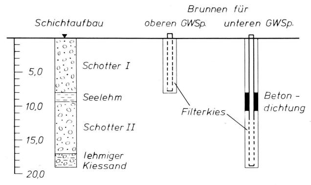
Abb. 11: Schema der Filterbrunnen für Schotter I und II. Letzterer mit Betondichtung auf der Höhe des Seelehms. (Schichtaufbau wie er beim Erstellen des Filterbrunnens FB 1 aufgeschlossen wurde).
