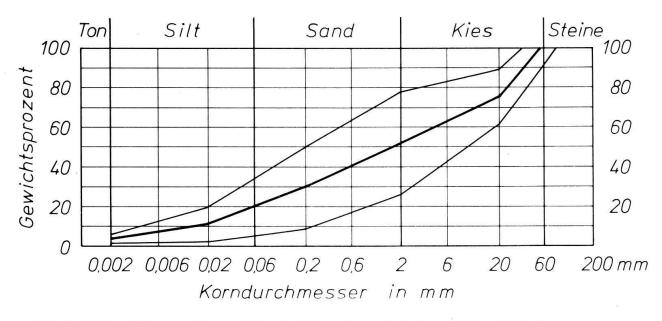
Abb. 5: Mittlere Kornverteilung mit Standardabweichung des Schotters II aus 16 Proben.
