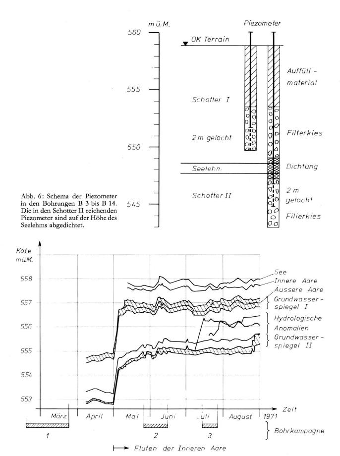
Abb. 7: Ganglinien der Wasserstände des Sees, der Inneren und der Äusseren Aare sowie in den Piezometern.
