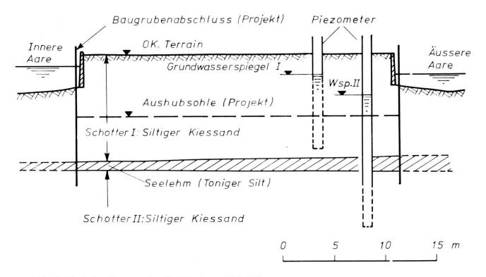
Abb. 2: Typisches Baugrundprofil. Schnitt ca. NE-SW.
