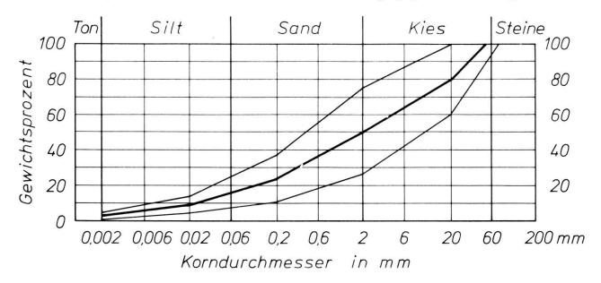
Abb. 3: Mittlere Kornverteilung mit Standardabweichung des Schotters I aus 19 Proben.
