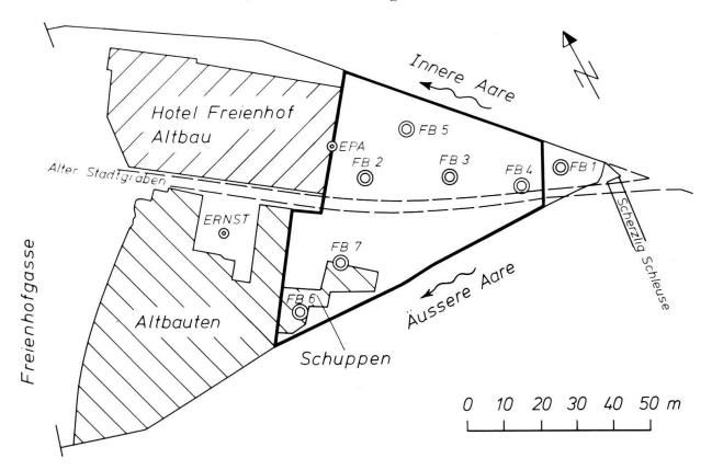
Abb. 10: Lage der sieben Filterbrunnen FB 1 bis FB 7 und der beiden bestehenden Wasserfassungen EPA und ERNST. FB 1 reicht in den Schotter II. Die übrigen Filterbrunnen dienen der Entwässerung des Schotters I zwischen Baugrubenabschluss und Seelehmschicht.
