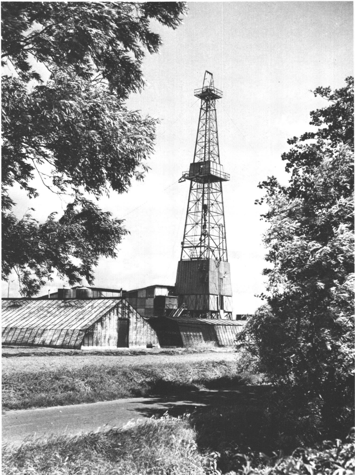
Fig. 3: Explorationsbohrung mitten im Treibhaus-Gemüseanbau in West Holland, De Lier. Der entstandene Kulturschaden wird vergütet. Eine Bohrlokation kann in der Regel soviel verschoben werden, dass Wohn- oder Industriekomplexe, unzugängliche Stellen etc. umgangen werden. Durch Ansetzen einer Schrägbohrung kann schliesslich der Bohrturm mehrere hundert Meter seitlich von seinem Endziel in der Tiefe aufgestellt werden.
