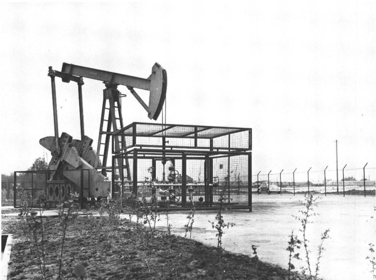
Fig. 6: Zweifacher Förderabschluss, eingegittert. Im Vordergrund Produktionskreuz einer eruptiv-fördernden Bohrung. Direkt dahinter eine Bohrung mit Pumpen-Förderung. Durch Anpflanzung von Sträuchern (Vordergrund) wird die Installation in weniger Jahren durch eine natürlich erscheinende Busch-Baumgruppe getarnt.
