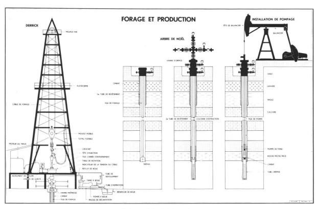
Bohr- und Produktionsschema
