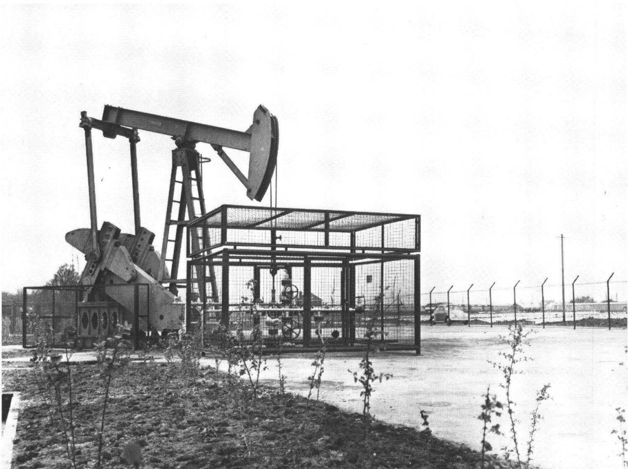
Fig. 6: Zweifacher Förderabschluss, eingegittert. Im Vordergrund Produktionskrenz einer eruptiv-fördernden Bohrung. Direkt dahinter eine Bohrung mit Pumpen-Förderung. Durch Anpflanzung von Sträuchern (Vordergrund) wird die Installation in weniger Jahren durch eine natürlich erscheinende Busch-Baumgruppe getarnt.
