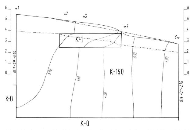
Fig. 2. Ecoulement en milieu hétérogène (surface piézométrique et équipotentielles). Nature de l'hétérogénéité: zone de perméabilité faible (K=1), dans milieu homogène (K=150). Légende: voir fig. 1. Lignes en tireté et en pointillé: explications dans le texte.
