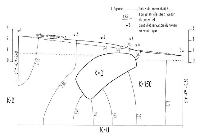
Fig. 1. Ecoulement en milieu hétérogène (surface piézométrique et équipotentielles). Nature de l'hétérogénéité: zone de perméabilité nulle (K=0), dans milieu homogène (K=150). Lignes en tireté et en pointillé: explications dans le texte.
