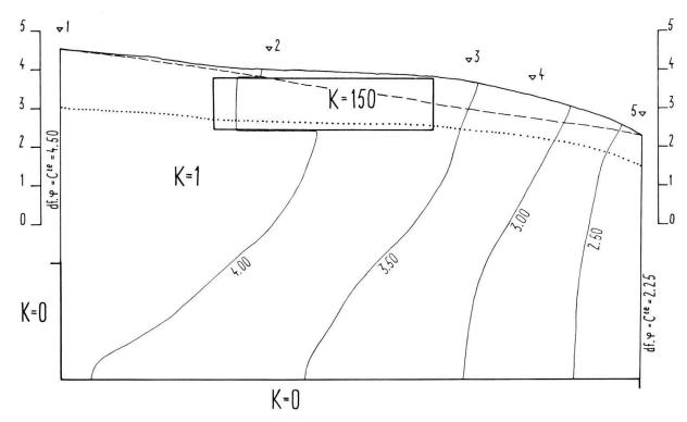
Fig. 3. Ecoulement en milieu hétérogène (surface piézométrique et équipotentielles). Nature de l'hétérogénéité: zone de perméabilité élevée (K=150), dans milieu homogène (K=1). Légende: voir fig. 1. Lignes en tireté et en pointillé: explications dans le texte.
