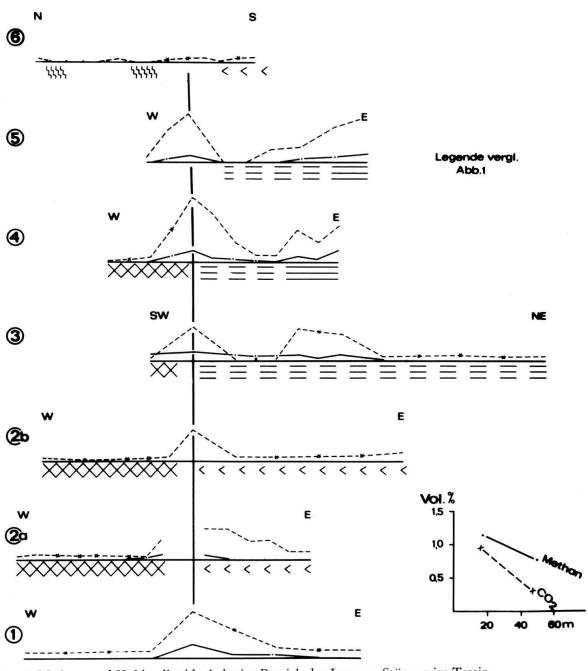
Fig. 4: Methan- und Kohlendioxidgehalte im Bereich der Luganer Störung im Tessin.
