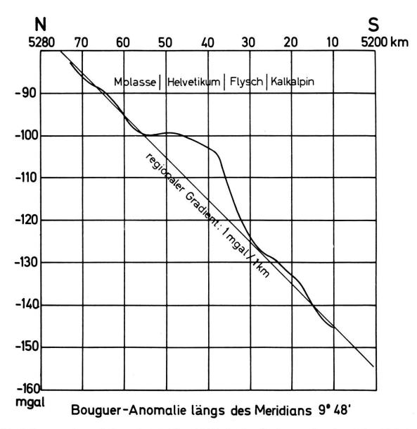
Abb. 2: Bouguer-Anomalie längs des Meridians 9°48′, darüber die Grenzen der tektonischen Einheiten. Die Diagonale stellt die angenommene regionale Anomalie dar. Die 4 mgal betragende Differenz zwischen den Messungen von Prakla und Dr. Zech ist ausgeglichen. Dadurch erscheinen die Restwerte im Südabschnitt um 4 mgal kleiner als in Abb. 3.
