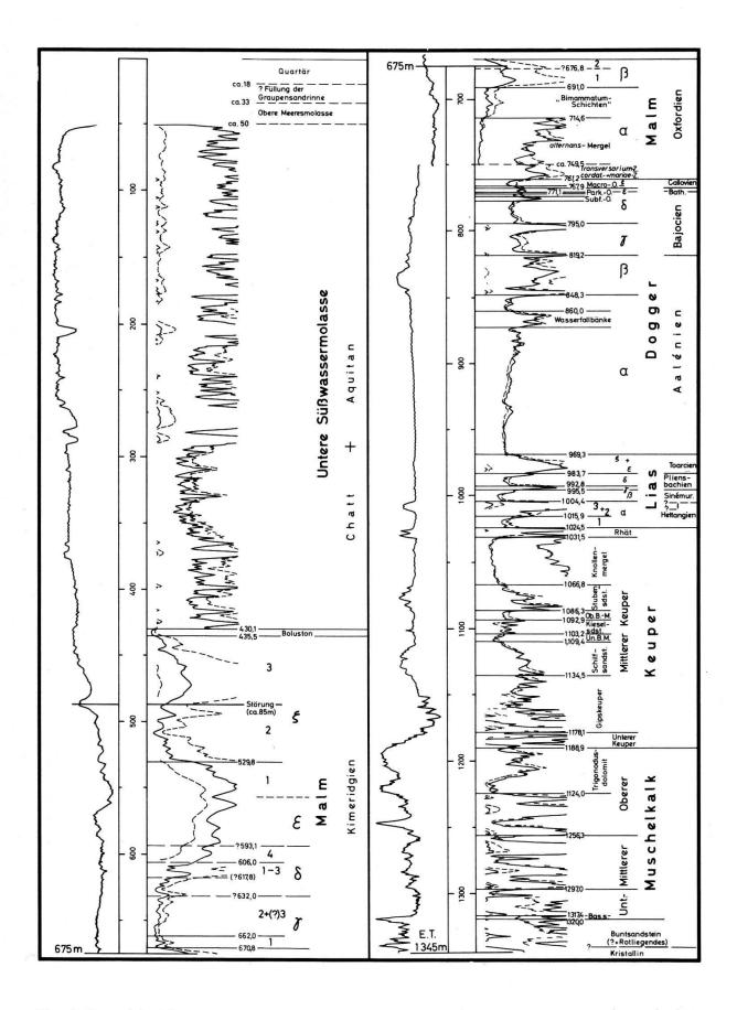
Fig. 1: Das Elektriclog (ES) der Bohrung Pfullendorf 3. – Links SP-Kurve (Spontaneous Potential), rechts elektrischer Widerstand.
