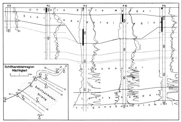
Fig. 2: Die Schilfsandsteinregion. – Verknüpfung der Elektriclogs für einen Schnitt durch die Schilfsandsteinrinne und Mächtigkeitskarte der Schilfsandsteinregion mit Angabe der Bruttomächtigkeiten (m). – Schwarz ausgezogene Säulchen: Kerngewinn-Strecken. – Der Schilfsandstein (i. w. S.) greift im (sandigen) Rinnenbereich auf tiefere Lagen des Gipskeupers über als im Bereich der (tonigen) Stillwasser-Fazies.
