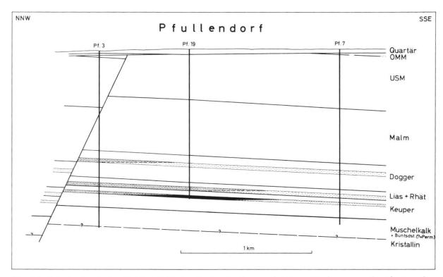
Fig. 16: Schnitt durch den Feldesteil Pfullendorf. – In den produktiven Horizonten: schraffiert = Gas, schwarz = Öl, punktiert = Wasser.
