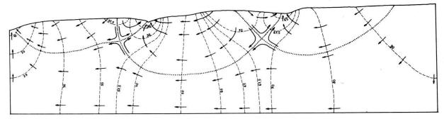
Fig. 1: Ecoulement en milieu homogène et isotrope. En tirets = équipotentielles. En pointillé = limite des systèmes d'écoulement.
