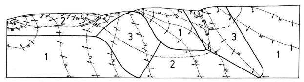
Fig. 4: Ecoulement en milieu hétérogène et anisotrope. Tirets = équipotentielles. Pointillé = limite des systèmes d'écoulement.
