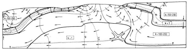
Fig. 2: Ecoulement en milieu hétérogène et isotrope. En tirets = équipotentielles. En pointillé = limite des systèmes d'écoulement.
