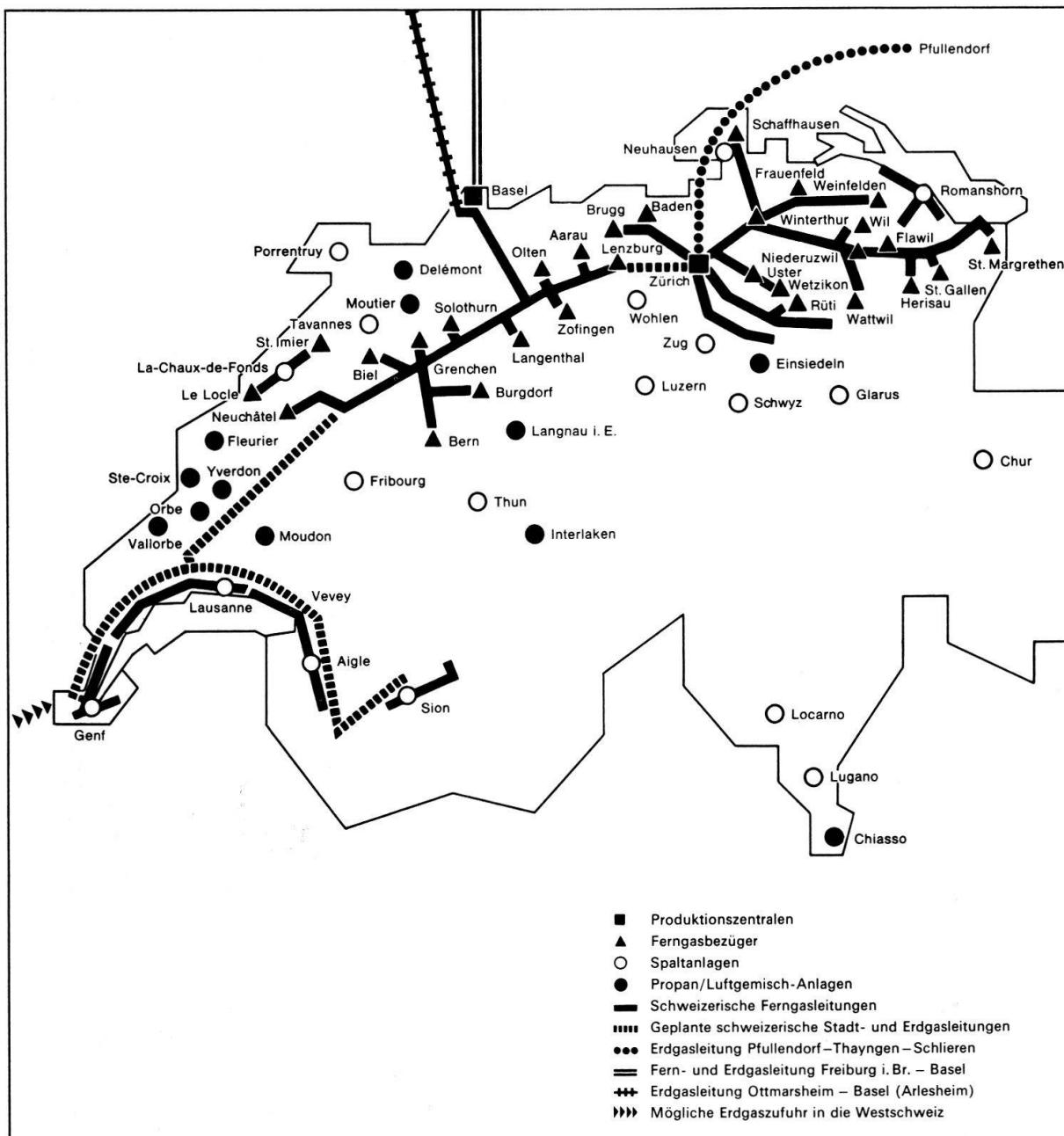
Für diesen Neubeginn wurde bereits manches getan. So bilden die in der zweiten Hälfte der sechziger Jahre gebauten Pipelinennetze der Gasverbund Mittelland AG von etwa 250 km Länge auf schweizerischem Gebiet und der Gasverbund Ostschweiz AG von etwa 200 km Länge bedeutsame Vorleistungen und zugleich unabdingbare Voraussetzungen für die Verwirklichung der Integration von Erdgas in die schweizerische Energiewirtschaft.
