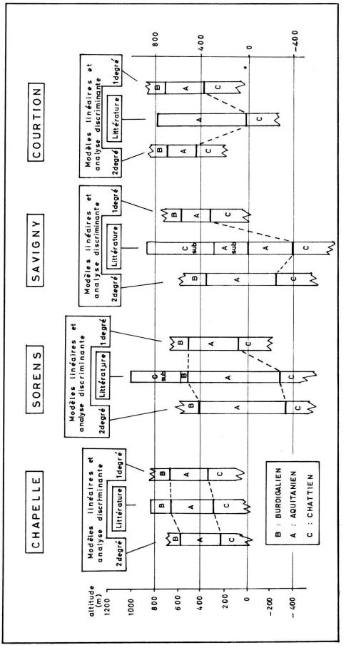
Fig. 5: Limites stratigraphiques et limites statistiques déterminées par analyse discriminante appliquée aux modèles linéaires de la résistivité électrique mesureé à la surface.
