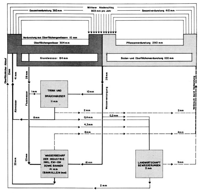
Aus der Darstellung des Wasserkreislaufes ist ersichtlich, was für Möglichkeiten der Wassernutzung natürlicherweise bestehen.
