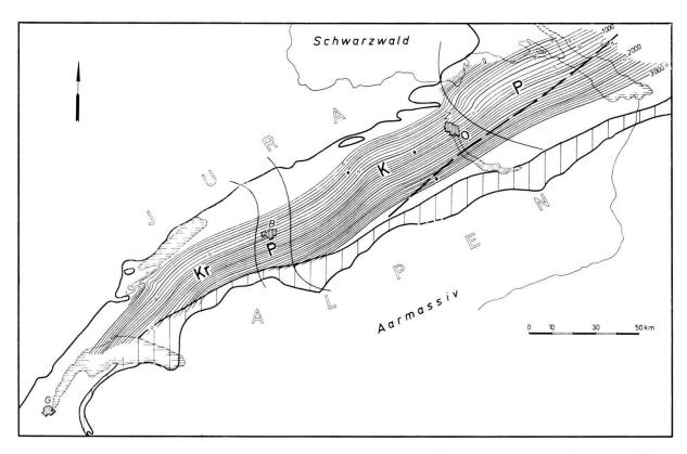
Fig. 5: Streichlinien der Tertiärbasis (m über/unter NN). – Unter dem Tertiär anstehendes Mesozoikum (nach Büchi, Lemcke, Wiener, Zimdars 1965, Fig. 17, S. 35): Kr = Kreide, P = Portlandien, K = Kimméridgien, O = Ober-Oxfordien; starke gestrichelte Linie: Mutmassliche NW-Grenze der Quintner-Kalk-Fazies; ausgefüllte Kreise: Bohrungen Pfaffnau-Süd 1, Boswil 1, Hünenberg 1; offene Kreise: Weitere für die Konstruktion der Streichlinien verwendete, publizierte Bohrungen.
