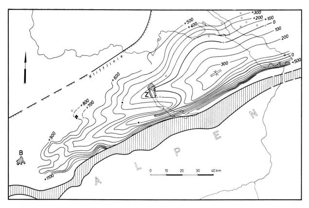
Fig. 6: Streichlinien der Oberkante der Oberen Meeresmolasse (m über/unter NN) nach Bohrungen und Oberflächengeologie. – Ausgefüllte Kreise: Bohrungen Pfaffnau-Süd 1, 2, 4 und 5, Boswil 1, Hünenberg 1; offene Kreise: Weitere für die Konstruktion der Streichlinien verwendete publizierte Bohrungen.
