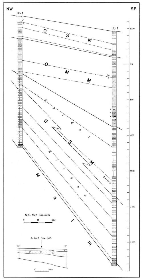
Fig. 4: Profilschnitt Boswil 1 – Hünenberg 1 (ohne Berücksichtigung etwaiger Störungen). – Alle Signaturen wie auf Fig. 2; Entfernung Bo. 1 – Hü.  $1=16,6\,\mathrm{km}$ .
