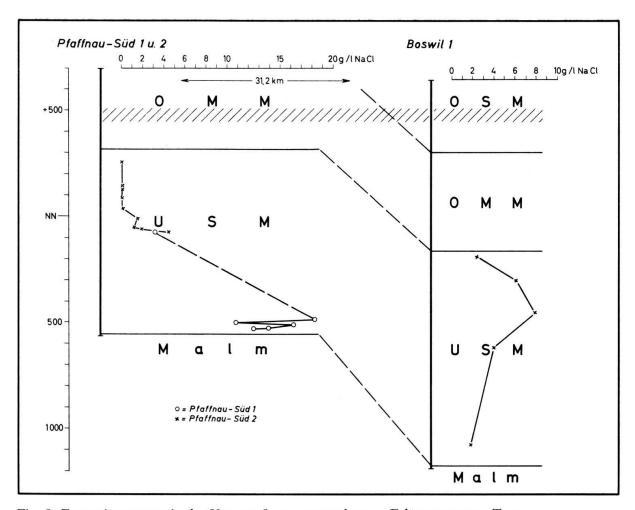
Fig. 8: Formationswässer in der Unteren Süsswassermolasse. - Erläuterungen s. Text.
