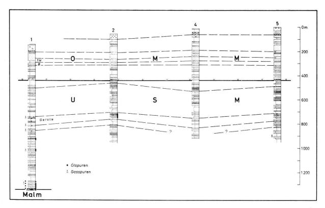
Fig. 7: Die Bohrungen Pfaffnau-Süd 1, 2, 4 und 5. – Ohne Längenmassstab, Verknüpfungen nach der Lithofazies oder nach Schlumberger-Diagrammen; Signaturen wie auf Fig. 2.
