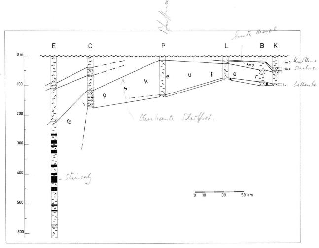
Fig. 6: Faziesschnitt durch den Keuper (ohne Rhät.). E = Essertines 1; km 5 = Knollenmergel, km 4 = Stubensandstein, km 3 = Bunte Mergel, ku = Lettenkeuper. Übrige Signaturen s. Fig. 3. Schichtgrenze oberhalb «Gipskeuper» = Oberkante Schilfsandstein (— Bereich).
