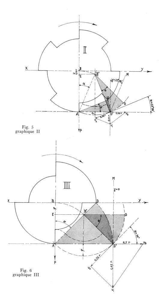
Jusqu'à présent, pour le forage des terrains durs, la pratique a déterminé deux paramètres : Vitesse de rotation lente. Très forte pression de l'outil sur le sol.
