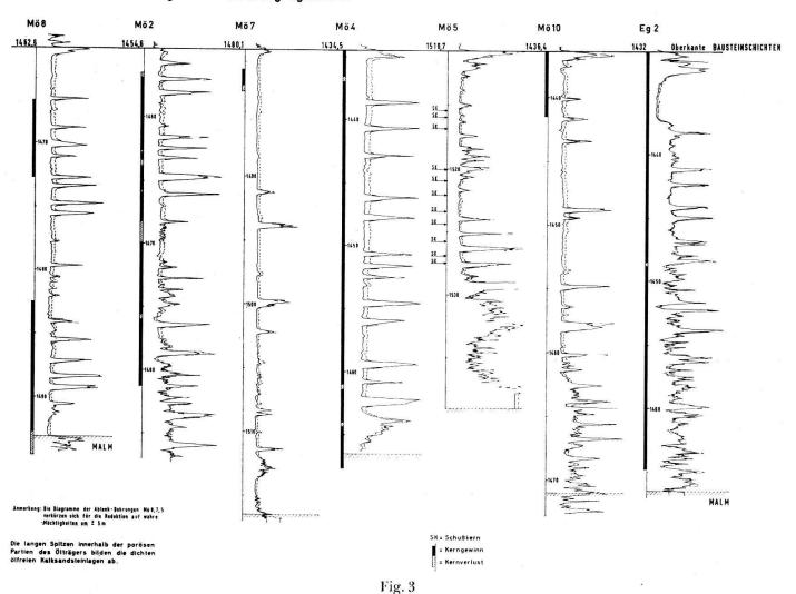
Die graphische Darstellung der Verhältnisse könnte darauf hindeuten, daß diese tiefere, feingeschichtete Partie nordwestwärts auskeilt, wobei ihre wohl zerlapptgebuchtet verlaufende Auskeillinie bereits mit der Bohrung Mönchsrot 8 überschritten wäre. Dort liegt die ölführende, kompakte Sandsteinfolge der Bausteinschichten direkt dem Malm auf (s. Fig. 3).
