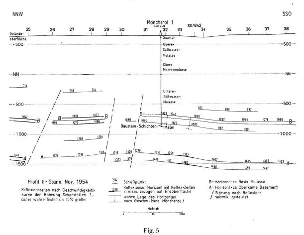
Fig. 5 gibt einen Abschnitt des seismischen Profils II der Fig. 4, in welchen das Bohrprofil der Mönchsrot 1 hineinprojiziert ist. Die Auswertung für die beiden Figuren besorgte Herr Dr. A. Custodis (Wintershall AG) nach Messungen der PRAKLA, Gesellschaft für praktische Lagerstättenforschung, Hannover.
