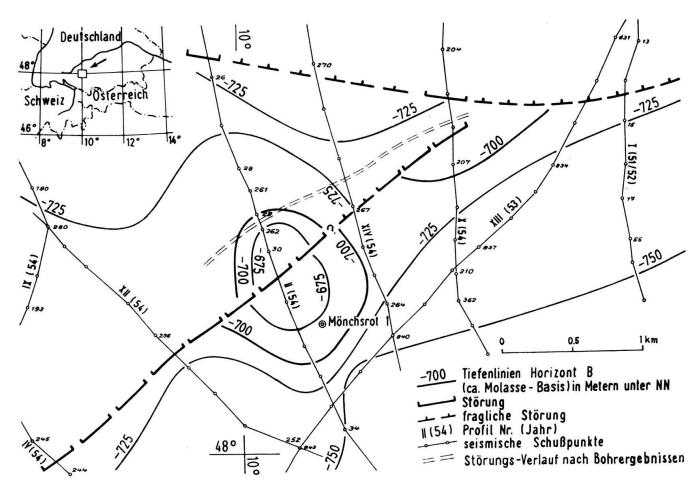
Fig. 4. Strukturplan nach reflexionsseismischen Messungen. Auswertung 1954.
