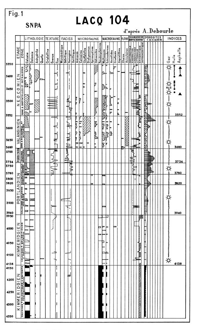
Fig. 1 — Tableau analytique des formations profondes de Lacq 104.
