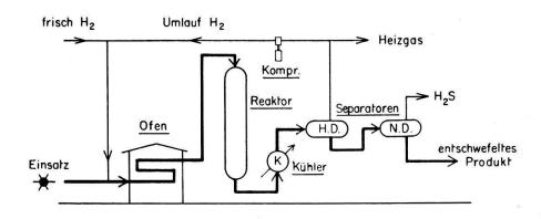
Abb. 2 Fließschema einer katalytischen hydrierenden Entschwefelungsanlage.
