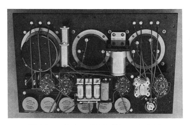
Bild 3. Gesamtansicht des geoelektrischen Meßgerätes ohne Deckel.
