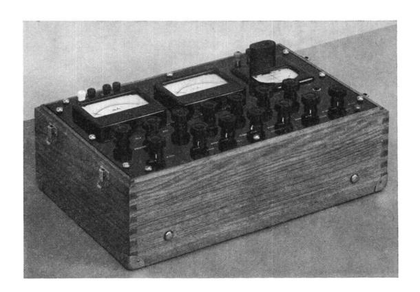
Bild 4. Innenansicht der Frontplatte des geoelektrischen Meßgerätes.
