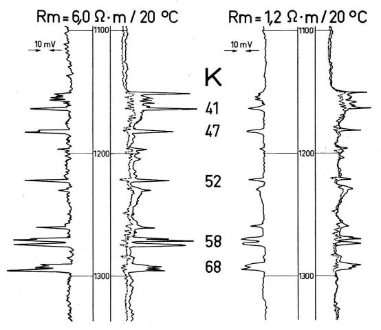
Abb. 1. — Elektrische Bohrlochsmessungen in der Bohrung Ampfing 9 bei verschiedenen Spülungswiderständen (Fa. Schlumberger v. 24. 10. und 4. 11. 55). — Die Faktoren K wurden für die einzelnen durchlässigen Schichten mit Hilfe der unterschiedlichen Potentialausschläge und Spülungswiderstände errechnet.
