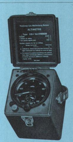
$\begin{array}{l} {\rm Messbereich} -500~{\rm bis} +2500\,{\rm m} \\ {\rm Messgenauigkeit} ~\pm 2\,{\rm m} \end{array}$
