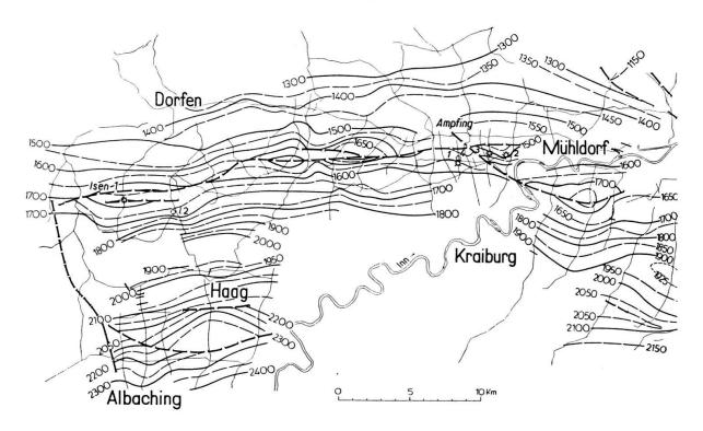
Fig. 2 Strukturkarte auf Basis Tertiär der Isen-Ampfing Störungszone nach Reflexionsseismik.
