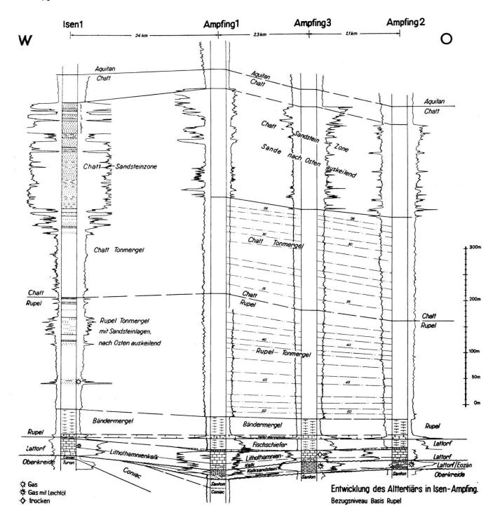
Fig. 5 Die prae-Aquitan Schichtfolge der Bohrungen Ampfing und Isen.
