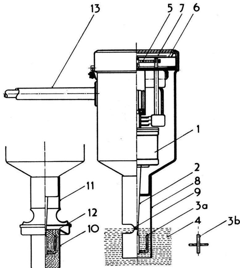
Fig. 1. DRAGE Torsion-Viscosimeter
