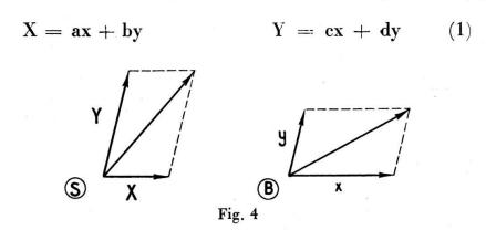
Ces équations représentent les relations fondamentales entre les composantes X, Y, x, y de la nappe uniforme. Réciproquement, si on peut établir entre les composantes mesurées sur le terrain des relations de cette forme, nous aurons la preuve qu'elles résultent de nappes infinies ou quasi infinies.
