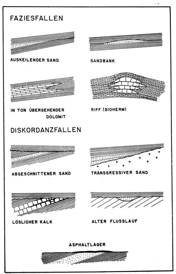
Fig. 2: Schematische Profile durch einige stratigraphische Fallen.
