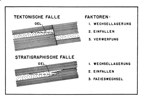
Fig. 1: Schematische Darstellung einer tektonischen und einer stratigraphischen Falle.
