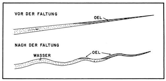
Fig. 4: Schematische Darstellung der Olansammlung in einer stratigraphischen Falle vor und nach einer Faltung.
