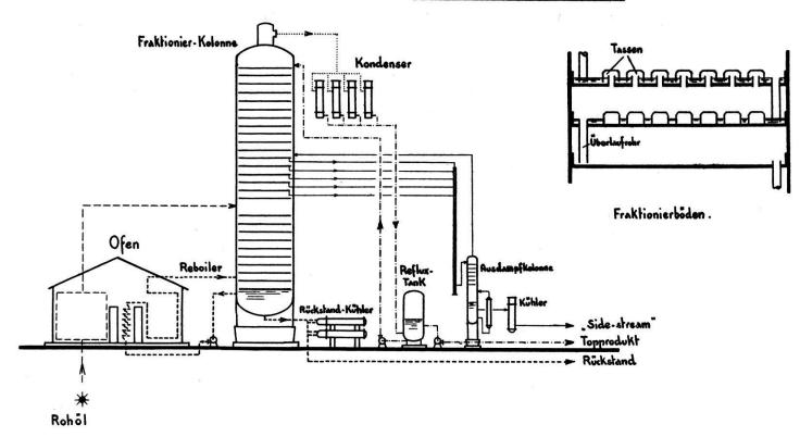
nung ankommt, auch von Böden aus verschiedenen Höhen Produkte einer zwischen Top- und Bodenprodukt liegenden Flüchtigkeit abzapfen. Man nennt diese "Side-Streams". So arbeiten z. B. die meisten Rohöldestillationsanlagen. Eine solche Einheit (Unit) vermag pro Tag bis zu 5000 m³ rohes Erdöl zu verarbeiten. Man nennt eine solche Anlage eine "Topping Unit".
