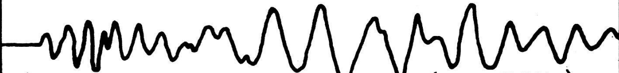
Figur 2. Seismogramm einer Sprengung, (ca. 1.Hälfte).
