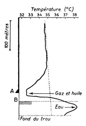
Fig. 4. — Détermination de venue d'eau par thermométrie.
