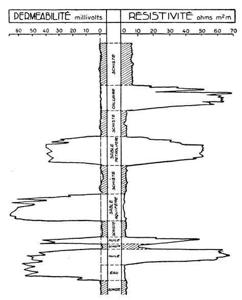
Fig. 2. Principes d'interprétation d'un diagramme de carottage électrique.
