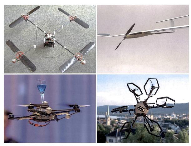
Abb. 6. Flugroboter: Erster Quadrotor, AtlantikSolar, Balancier-Drohne, Voliro.
