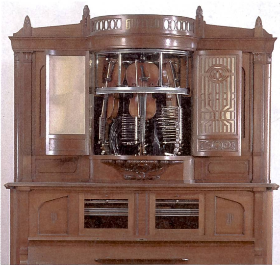
Abb. 5. Phonoliszt-Violine (1908). Der nach wie vor betriebsfähige Violinautomat der Firma Ludwig Hupfeld AG, Leipzig, besteht aus einem Klavier und drei sich drehenden Geigen. Die Steuerung erfolgt über eine Papiernotenrolle (© Technisches Museum Wien).
