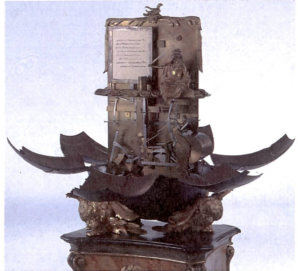
Abb. 2. Allerschreibende Wundermaschine (1760). Das Steuerwerk dieses Handschriftautomaten von Wolfgang Knaus befindet sich in der (hier geöffneten) Weltkugel. Die kleine Messingfigur (oben) ist mit einer Schreibfeder ausgestattet (© Technisches Museum Wien).
