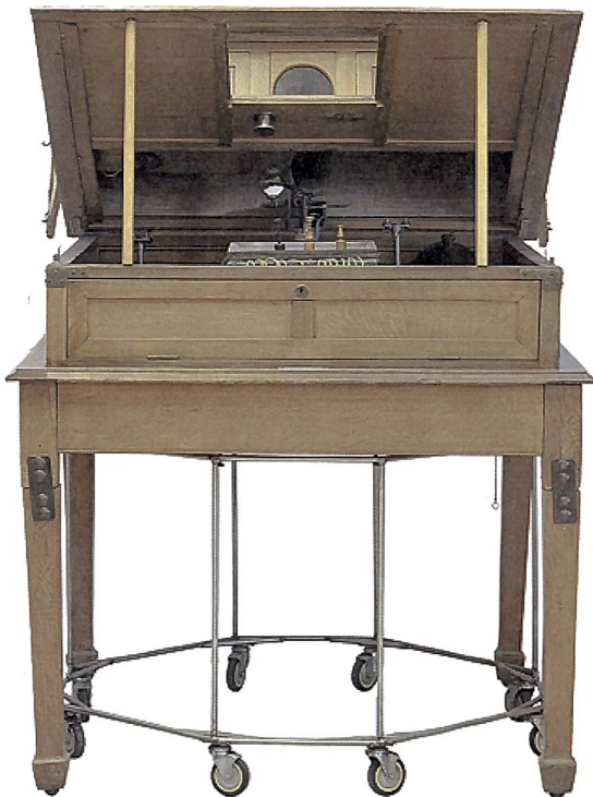
Abb. 6. Schachautomat von Leonardo Torres Quevedo (1920). Norbert Wiener spielte 1951 auf der Pariser Kybernetikkonferenz gegen diese Endspielmaschine (© Museo Leonardo Torres Quevedo, Madrid).
