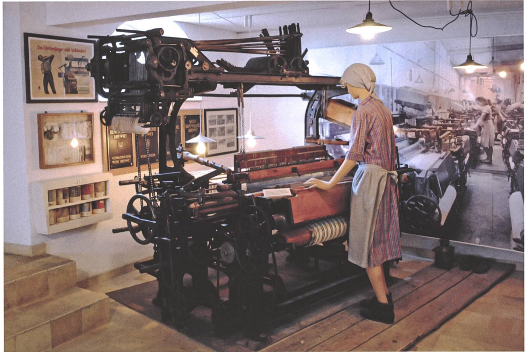
Abb. 6 Ein Mechanischer Webstuhl im Brennet-Textil- museum in Wehr, wie er noch bis in die 1920er Jahre bei der MBB im Einsatz war.
