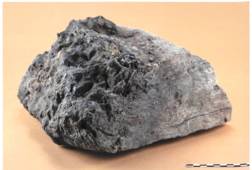
Abb. 16 Aufgeschmolzener und verschlackter Gneis- brocken einer Ofenschachtwand.
