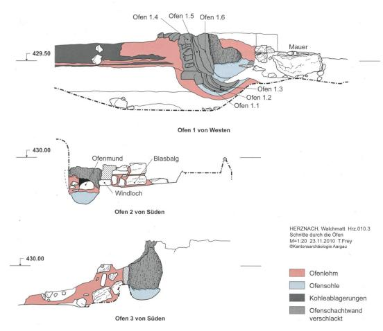
Abb. 14 Schnitt durch die Öfen. Ofen 1 Ansicht von Westen, Ofen 2 und 3 von Süden.
