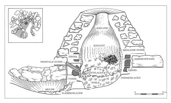
Abb. 4 Schema eines archäologisch untersuchten Rennofens von Boécourt, Kt. Jura.
