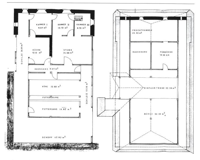
Abb. 7: Grossherrischwand DE, Klausenhof. Grundrisse Erdgeschoss Obergeschoss (Längsschnitt) zeigen den inneren Aufbau eines strohgedeckten Firstständerbaus. Der Wohnteil wurde nachträglich um Raumtiefe vergrössert.
