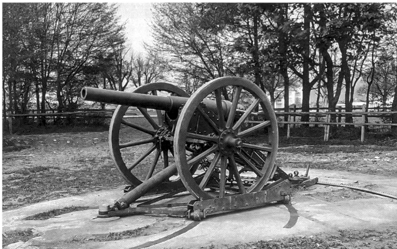
Abb.3: 8,4-cm-Feldgeschütz (hier mit hydraulischer Rücklaufbremse). (Foto KW-SW)
