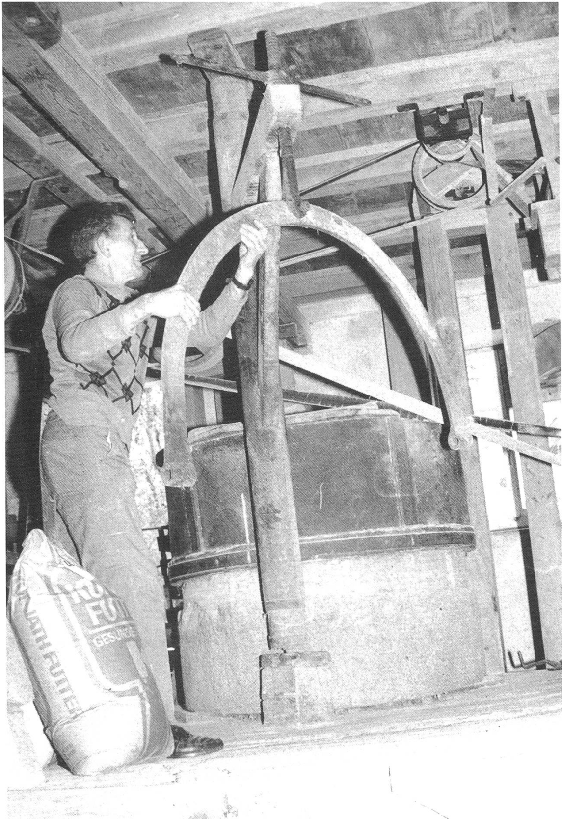
Müller Gottfried Schraner hantiert am Galgen, der zum Abheben und Wenden des Läufersteins dient. (Fotos: Dominik Senn)
