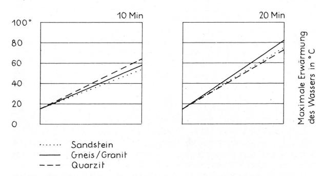
Abb. 10 Versuchsergebnisse mit neuen Hitzesteinen. Volumenverhältnis von Stein: Wasser = 1:4. Die Steine wurden während 10 resp. 20 min. erhitzt.
