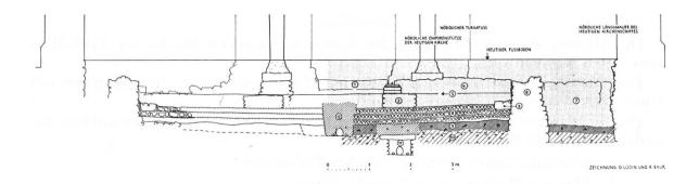
Abbildung 2 Querschnitt vor den Emporenstützenfundamenten
