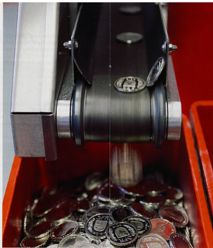
Die Prägemaschine spuckt pro Minute rund 130 Nominalen (zum Beispiel 5 Rappen) sind bis zu
