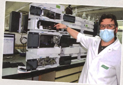
High Performance Liquid Chromatography (HPLC): Sie dient der Gehaltsbestimmung von Leitsubstanzen, erklärt Reto Brunschwiler, Leiter Qualitätskontrolle.
