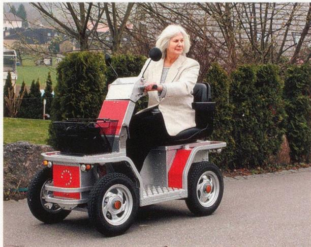
Das Elektromobil Pony fährt energiesparend und verursacht keinen Lärm und keine Abgase. Mit dem leistungsstarken Elektromotor können Sie auch längere Fahrten unternehmen. Das Herzstück besteht aus zwei wartungsfreien Batterien, die Sie zu Hause an einer gewöhnlichen Steckdose laden können.
