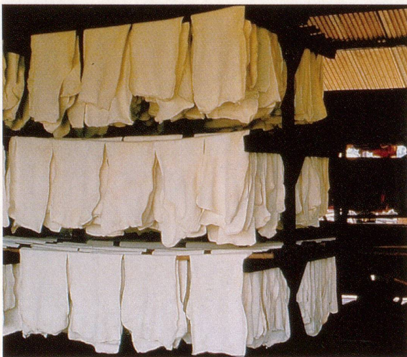
Das geronnene Latex wird gewaschen, gepresst und in Räucheröfen getrocknet.
