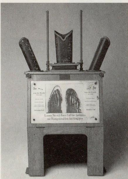
**Auf der Suche nach dem passenden Schuh wurden in den leichtsinnigen 50er Jahren sogar Durchleuchtungsapparate mit Röntgenstrahlen und drei Blickschächten eingesetzt.**
