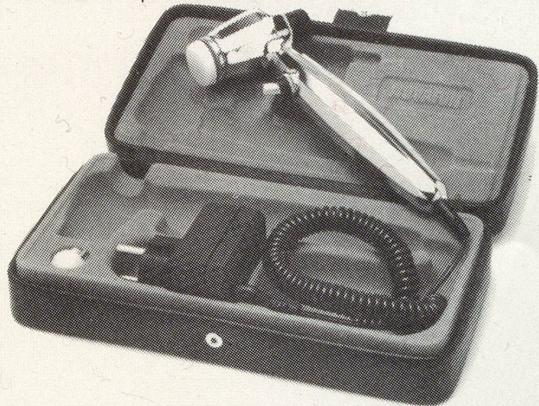
Das **NOVAFON Intraschallgerät** erzeugt solche Schwingungen (100 bis 10 000 pro Sekunde) und überträgt sie auf einen kleinen, ca. 2,5 cm grossen Schallteller. Streicht man nun mit diesem Schallteller leicht über den Körper – zum Beispiel über eine schmerzende Stelle – so dringen diese Schwingungen bis zu 60 mm in das Körperfeste ein und erzeugen dort eine äusserst intensive Art von Massage. Dadurch wird die Durchblutung verstärkt und der Stoffwechsel des Gewebes gesteigert.
