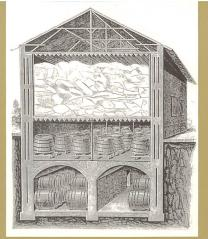
Coupe d'une glacière avec les caves de garde au sous-sol, les cuves de fermentation à l'entresol et le dépôt de glace naturelle au-dessus. On distingue bien le système de climatisation des locaux dans l'épaisseur des murs permettant à l'air froid de descendre jusqu'aux cayes (ABC)
