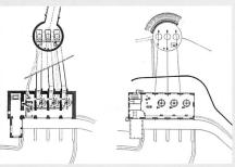
Coupe de l'usine et de la chambre de mise en charge,
