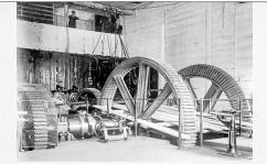
Groupe de 300 CV pour les pompes avant l'installation des génératrices en 1891
