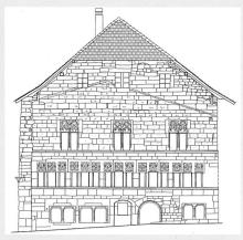
Elévation de la façade pignon sur rue avec trace d'un avant-toit la protégeant (SAEF 1997)
